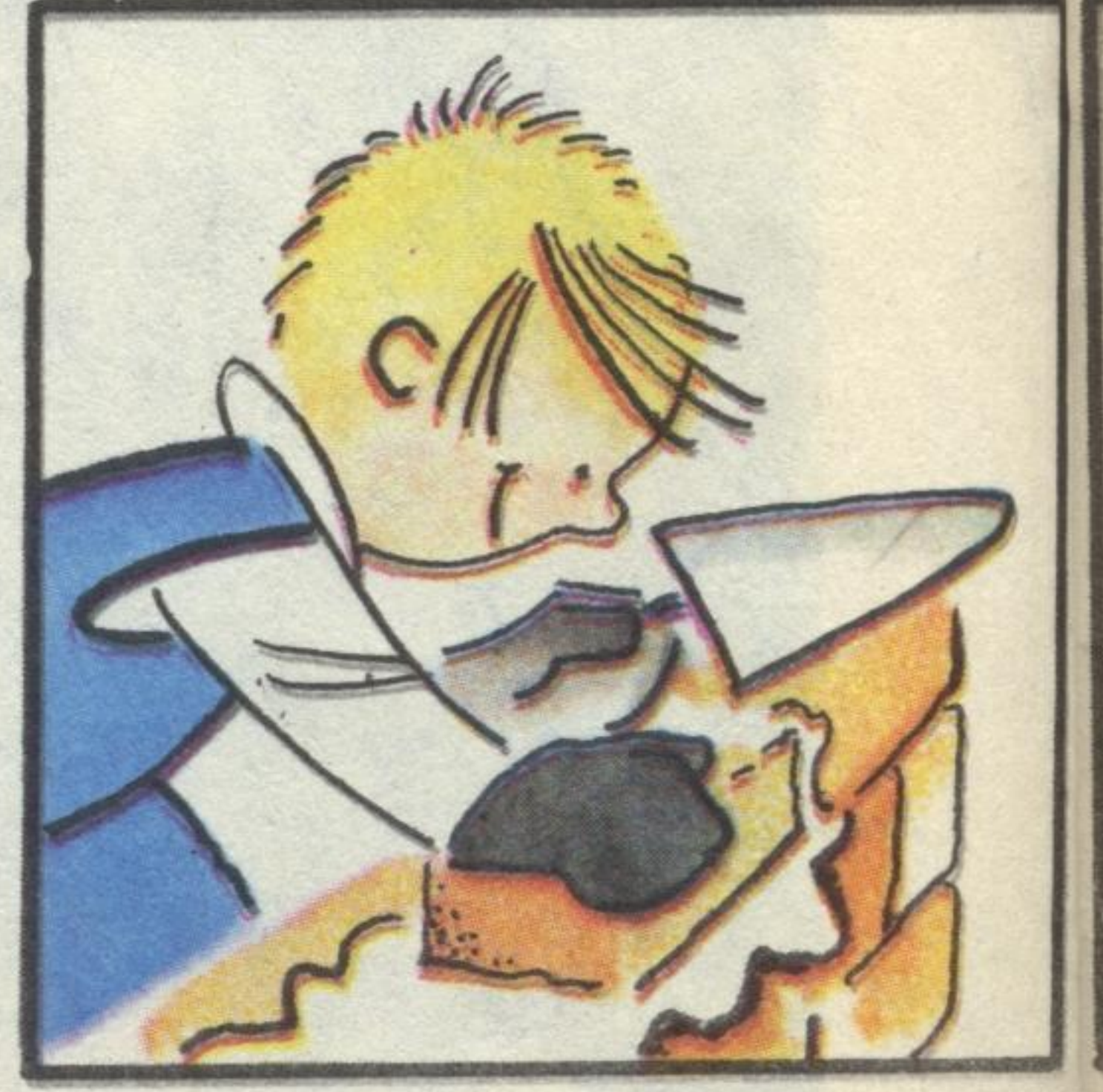
Выравнивайте растворную «постель», прижмите часть раствора к вертикальной грани ранее уложенного кирпича.
